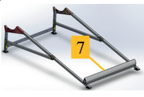
B7- Lắp giá đỡ ống
